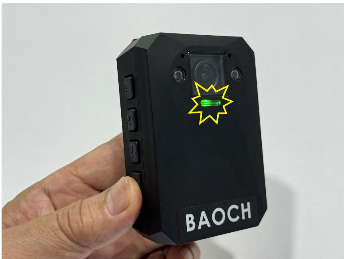
電源開啟 15 秒後 前方綠燈熄滅、後待 5 秒鐘後攝影機系統啟動
